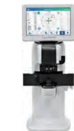
Kedvező árú, minőségi belépőmodel a digitális dioptriamérők világába. Nagyméretű színes LCD érintőkijelzővel és patronos lencsejelölővel rendelkezik. A Hartmann-Schack szenzor gyors mérést biztosít multifokális lencsék esetén is. PD, UV és kék fény (415 nm & 460 nm) mérési funkciót is kínál. Made by Huvitz.
